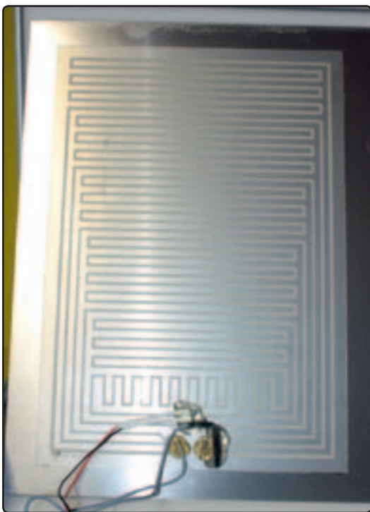
Die Heizmatte ist flächendeckend auf der Aluplatte angebracht. Die hier zu sehenden Ränder sind im kompletten Aufbau mit Dämmmaterial versehen
