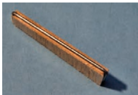
... deshalb habe ich ihn vorsorglich mit einem Stahldraht verstärkt.
