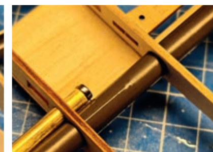
Die Neodym-Magnete am Ende der Messingröhrchen halten später die Flächensteckungen aus Stahldraht fest
