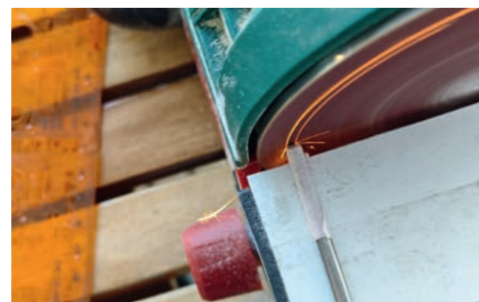
Mit einem Tellerschleifer begradiige ich die Enden des Stahldrachts der Flächensteckung
