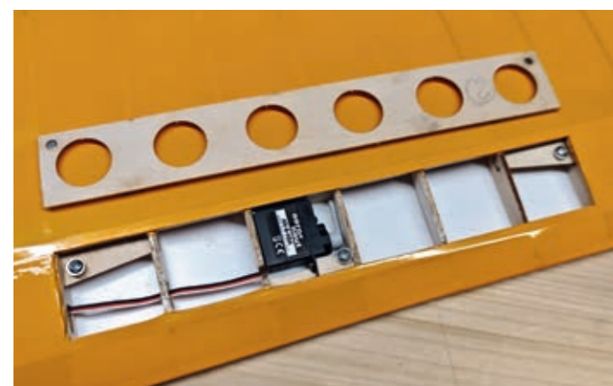
Die Bremsklappen werden von einem Servo rausgedrückt. Im Gleitflug werden sie durch kleine Magnete fixiert
