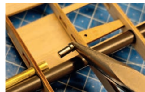
Die Neodym-Magnete am Ende der Messingröhrchen halten später die Flächensteckungen aus Stahldraht fest
