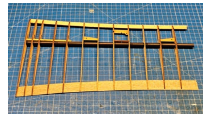
Die Kohleholme, hier der rechte Innenflügel, sind großzügig dimensioniert und machen die Konstruktion auch ohne Beplankung drehsteif
