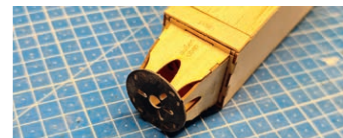
Konisch zulaufender Dom aus Sperrholzteilen. Der Motorspant ist aus CFK und hat schon passende Aufnahmen für den Dualsky-Brushless-Antrieb
