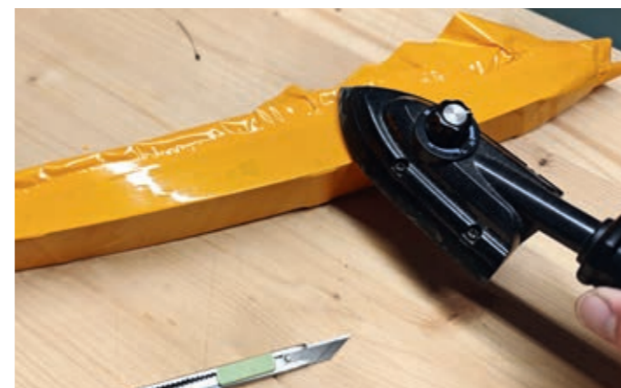
Die Anleitung empfiehlt die klassische Oracover-Folie als Bespannung, so habe ich es dann auch gemacht und bin sehr zufrieden mit dem Ergebnis
