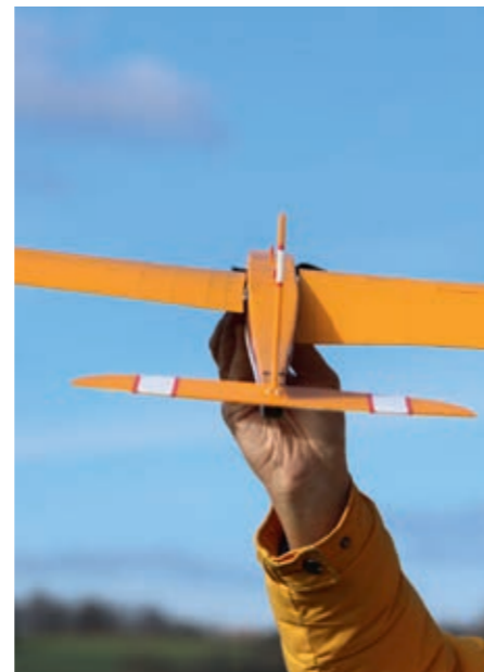
Der Clou beim Fitis nova ist die Flächensteuerung – hier würde eine Linkskurve geflogen
