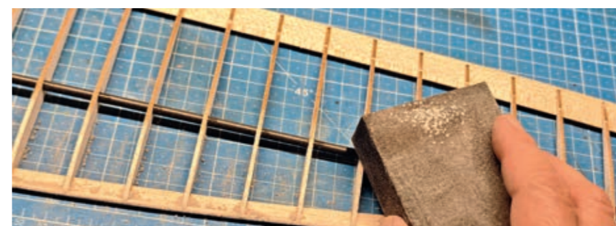
Der braune Laser-Abbrand auf den Rippen ist mit dem Schleifschwamm schnell entfernt, generell gibt es am Tragflächenrohbau nicht viel zu Verschleifen
