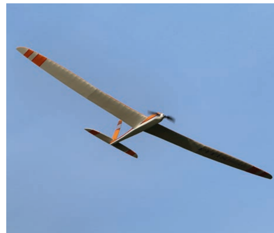
Schaut man genauer auf die Flügelstellung, lässt sich die Verdrehung erkennen, über die der Fitis nova gesteuert wird
