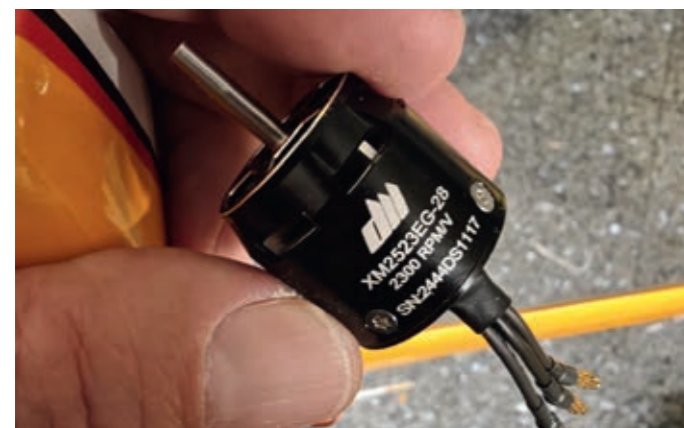
Der Dualsky-XM 2523 ist gekapselt, sodass keine außen drehende Glocke schleifen könnte
