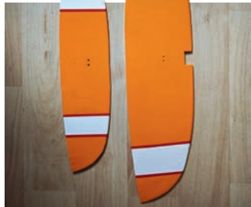
Das neue Höhenleitwerk hat doppelt so viel Fläche wie die Urversion, beim Seitenleitwerk ist das genauso. Dadurch haben sich die Flugeigenschaften entscheidend verbessert
