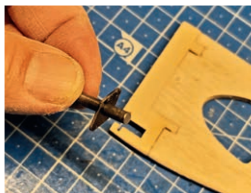
Das Ruderlager aus 4-mm-Stahldraht wird mit einem CFK-Ruderhorn verklebt und dient so auch zur Anlenkung des Pendelseitenruders
