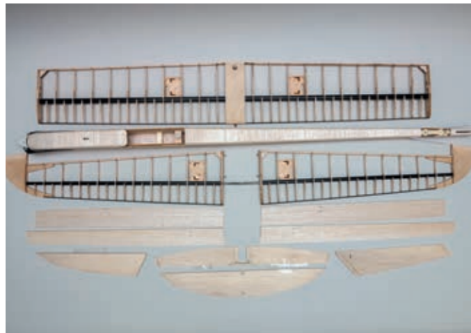
Rumpf und Tragflächen sind rohbaufertig. Als Nächstes steht das Folieren und Anscharnieren der Ruder an
