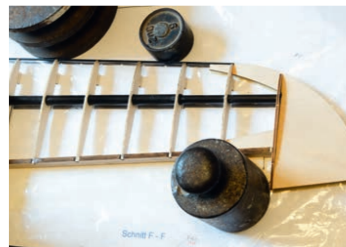
Beim Verkleben von Nasen- und Querruderanschlagleiste des Tragflächenendteils helfen Gewichte. Die 3D-Darstellung im Bauplan macht die Montage einfach
