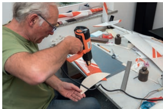
Mit einem temperaturregulierten Heißluftfön kann man die Spannung aufbauen. Bereits verklebte Teile sollten abgedeckt werden
